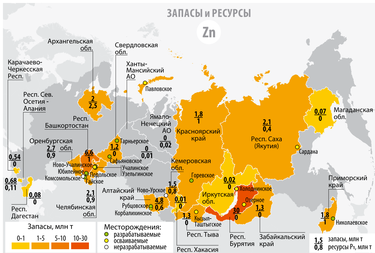
Основные месторождения цинка и распределение его запасов и прогнозных ресурсов категории P_1 (млн т) по субъектам Российской Федерации
