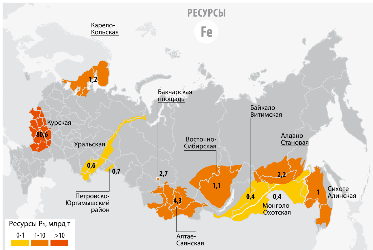
Ресурсный потенциал железорудных провинций и рудных районов и площадей Российской Федерации, млрд т
